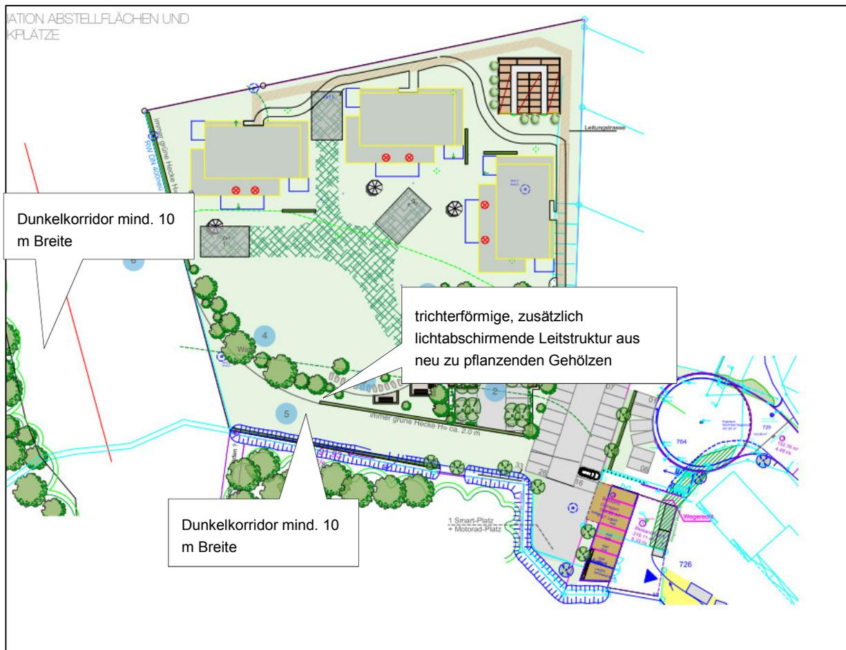
**Abbildung 9** Planung mit zwei Dunkelkorridoren für Fledermäuse und einer trichterförmigen Strauchpflanzung als Leitstruktur für strukturgebunden fliegende Fledermäuse
